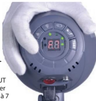
« C0 » correspond au mode de reconnaissance automatique. Utilisez le flash de l'appareil photo et réalisez un test d'exposition. La photocellule détecte le nombre de flashes réalisés par l'appareil photo et mémorise automatiquement la valeur.
