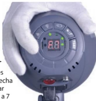
«C0» es el modo de reconocimiento automático. Use el flash de la cámara y realice una exposición de prueba. La célula fotoeléctrica detecta el número de flashes que realizó la cámara y memoriza el valor de forma automática.
