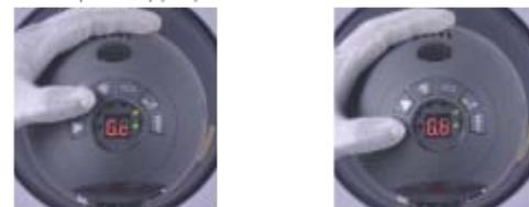
Lorsque le flash de studio et la télécommande VC-801TX sont réglés sur le même canal et le même groupe, la sortie du flash et la lampe pilote peuvent être contrôlées à distance.
