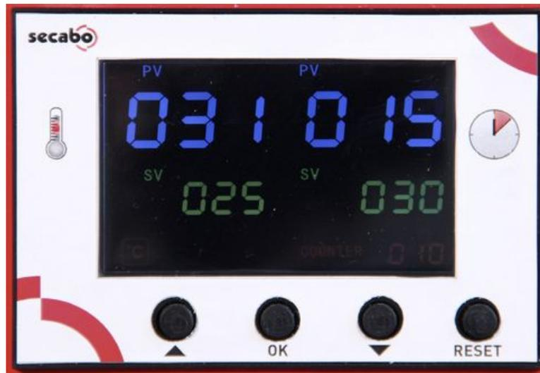
L'afficheur digital central permet le réglage de la température désirée (°C ou °F) et du temps en secondes. Les chiffres verts représentent les valeurs programmées, tandis que les chiffres blancs représentent les valeurs réelles. En bas à droite le compteur est affiché indiquant les nombres de pressages effectués depuis la dernière remise à zéro.
