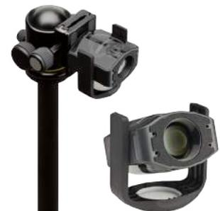
**Caractérisation de projecteurs** : faites tourner le bras du diffuseur ambiant pour l'utiliser comme support à des fins de positionnement ou utilisez le trépied fileté intégré pour les plus grandes salles.
