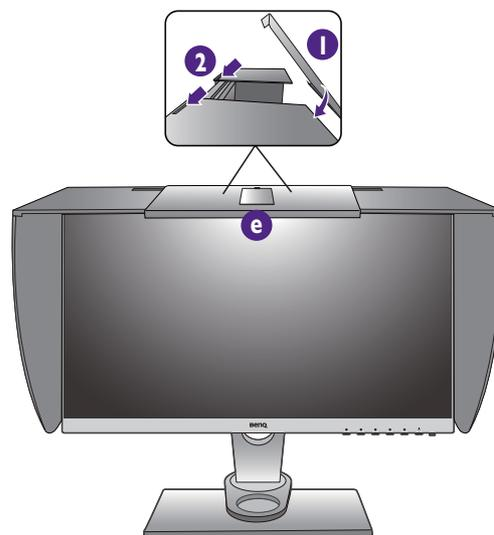
7. Si vous souhaitez calibrer la couleur de l'écran avec un colorimètre, faites glisser le composant **e** vers le bas de sorte que le colorimètre puisse être installé.
