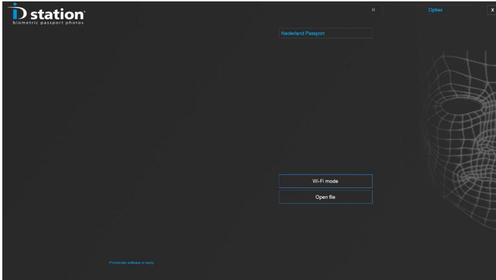
S'il y a un point d'exclamation rouge sur le bouton "Mode Wi-Fi" l'ID station n'est pas encore connecté au boîtier CamFi. Cliquer sur ce bouton pour forcer l'ID station à se connecter au boîtier CamFi.
