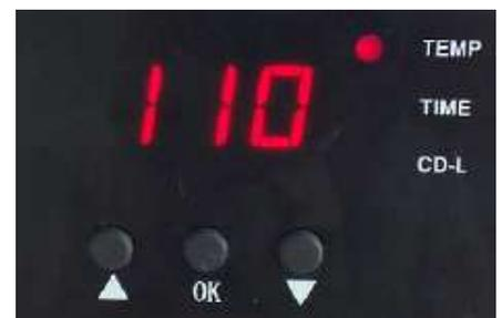
**Attention : la température doit être inférieure à 225°C.**
